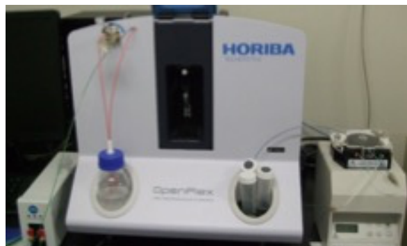
図2 表面プラズモン共鳴現象を捉える装置
