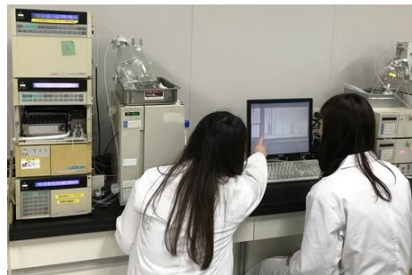
高速液体クロマトグラフ (HPLC) (遊離アミノ酸等を測定)
